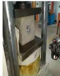
图2.4-2 带有二维编码的混凝土试块
