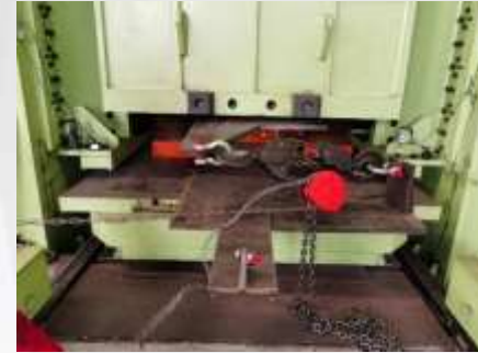
拉动手拉葫芦，模拟梁转动
