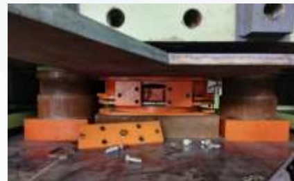
拆除调整块限位挡板
